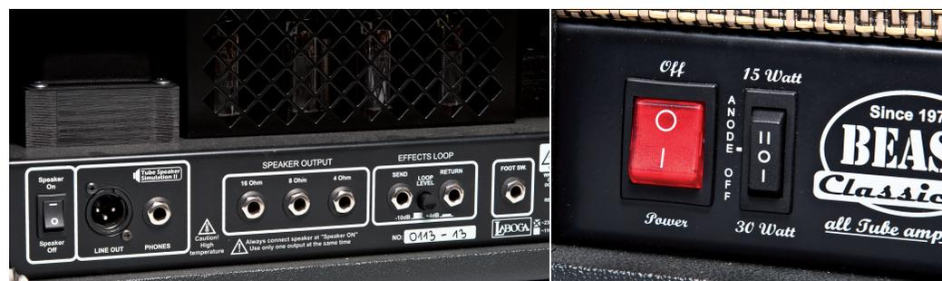
simple, avec un bouton Character en guise d'égalisation, un gain et un mini bouton-poussoir Crunch. Le canal Drive est doté d'une égalisation grave et aiguë avec un mini bouton qui active les médiums. Ces deux canaux sont commutables soit en façade, soit avec un footswitch (en option). On rajoute le volume général et le sélecteur de puissance. L'arrière est très complet avec une boucle d'effet, les prises pour baffles (4, 8 et 16 ohms) ainsi que la section simulation HP
