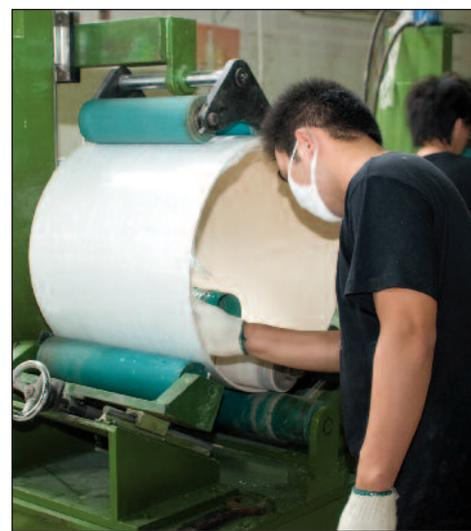
Le gabarit et la presse restent des outils incontournables pour donner au fût sa forme ronde. Il faut ensuite procéder au ponçage fin à l'aide de tours à haute vitesse, l'objectif étant d'obtenir un toucher parfaitement lisse, sans aucune aspérité. Les contrôles manuels et visuels sont constants.
