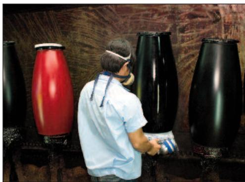
Plusieurs employés s'activent aux opérations de vernis. Ils sont munis de masque pour éviter d'inhaler les produits chimiques, et la cabine dispose d'un système d'aspiration de l'air.
