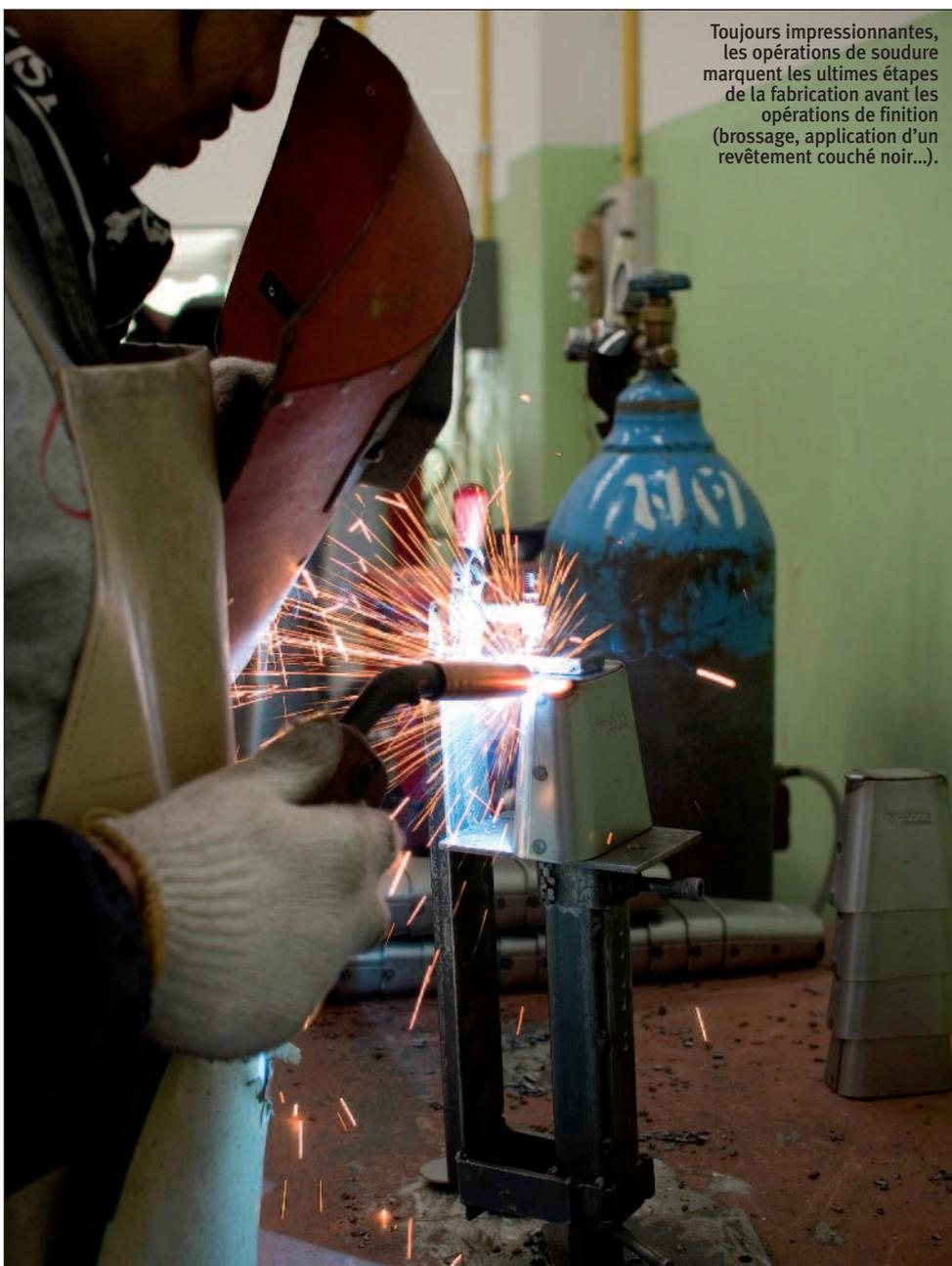
Toujours impressionnantes, les opérations de soudure marquent les ultimes étapes de la fabrication avant les opérations de finition (brossage, application d'un revêtement couché noir...).
