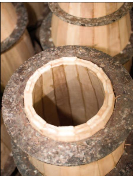
La mise en forme est l'une des opérations les plus délicates car il faut s'assurer que le fût ne subit aucune déformation pendant que la colle prend. On voit ici clairement la construction en deux plis.
