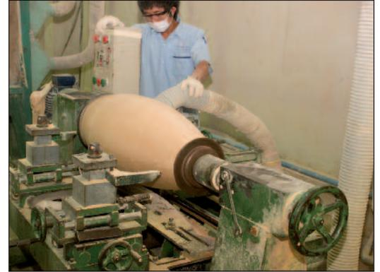
Le ponçage du fût permet d'obtenir une surface parfaitement plane, sans aucune aspérité. Indispensable avant la pose de l'apprêt et du vernis. On s'assure également que le façonnage permet la pose des cercles.
