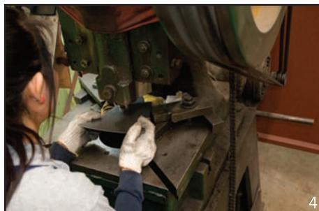
est placée sous une presse qui va lui donner la forme d'une moitié de cloche. Des moules différents sont utilisés pour chaque type de cloche. (photo 5, 6, 7). On soude, ensuite, les deux parties de la cloche, grâce à plusieurs points de soudure : voilà
