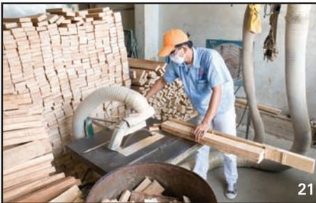
l'humidification et le séchage, jusqu'à la découpe, sous la forme de lattes qui serviront à construire les fûts. » (photo 21, 22)
